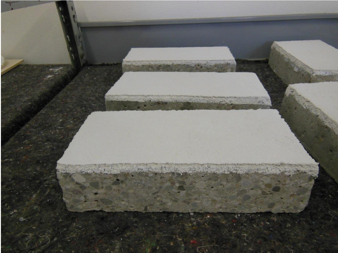
Fig.12: Tipologia di intervento con Thermorasante : macro
